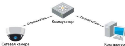
Рисунок 3-2 Соединение через коммутатор или роутер
